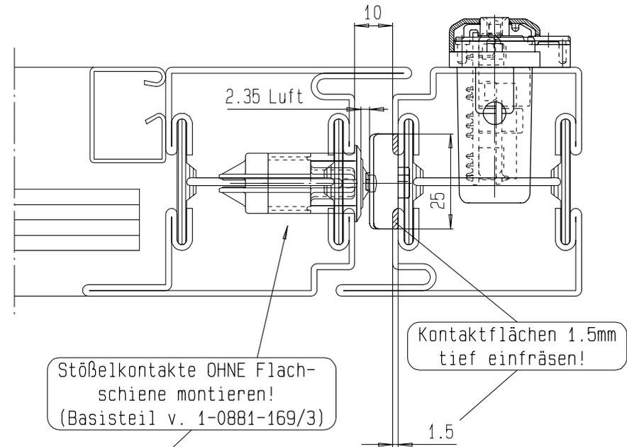
Stößelkontakte OHNE Flachschiene montieren!
